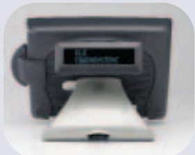
Optionales rückwärtig angebrachtes VFD-Kundendisplay
