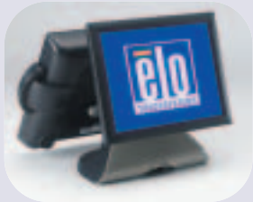
Optionales rückwärtig angebrachtes 12,1"-Kundendisplay mit und ohne Touch-Funktion
